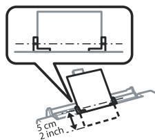
Загрузите конверт узкой стороной вперед с клапаном, обращенным вниз, и по центру заднего слота подачи бумаги, а потом установите боковую направляющую.
