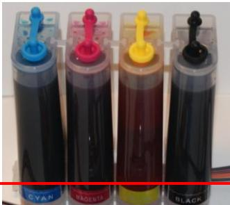
2. Дозаправив все емкости СНПЧ, закрываем заправочные отверстия (18) резиновыми пробками.
