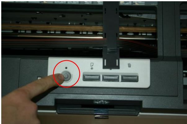
**12. Подключаем принтер к сети, включаем его.**
