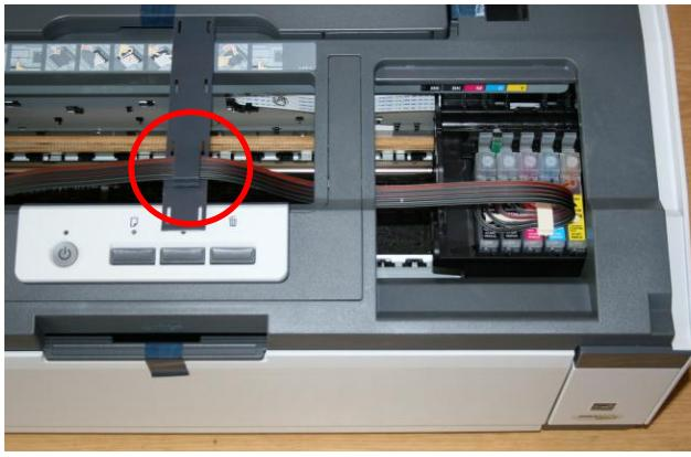
**5. Закрепите шлейф СНПЧ на креплении-планке (5) с помощью защелки**
