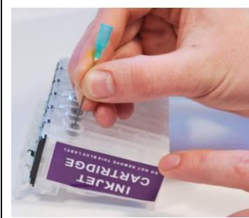
**2.** Берём картриджи СНПЧ (11), переворачиваем их и **АККУРАТНО** пробиваем иглой защитную пленочку на обратном клапане картриджей.
