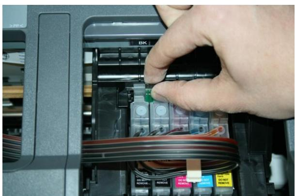
3. В позиции замены картриджей зажимаем кнопку обнуления чипа **(15) двумя пальцами** (чтобы не поломать) на 10 секунд.
