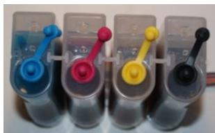
1. Открываем на емкостях СНПЧ вентиляционные отверстия (17).
