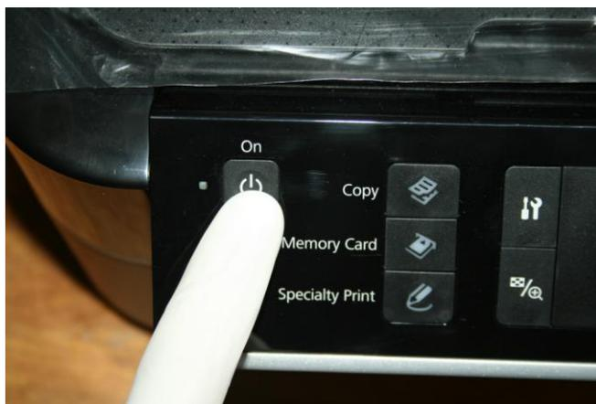
12. Подключаем принтер к сети и включаем его. Далее, как правило, каретка немного подвигается и остановится в крайнем правом положении,
