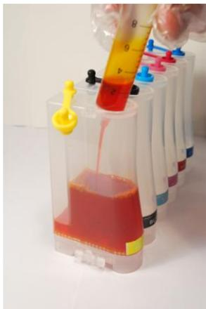
2. Открываем заправочное отверстие (20) на емкости, в которую будем заливать чернила. Затем берем шприц и вынимаем поршень. Вставляем носик шприца в заправочное отверстие (20). Используя шприц в качестве лейки, заливаем чернила в чернильную камеру (4). Залив чернила, закрываем заправочное отверстие (20). Аналогично заправляем остальные чернильные камеры, используя отдельный шприц для каждого цвета.
