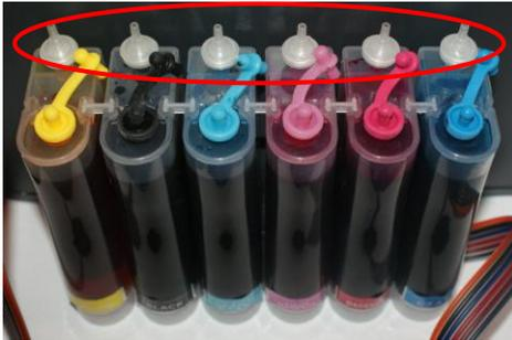
**10.** На емкостях СНПЧ открываем вентиляционные отверстия (19), вставляем в них вентиляционные фильтры (1). Таким образом, в процессе работы чернила в СНПЧ будут замещаться воздухом.
