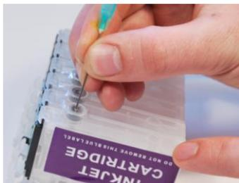
2. Берём картриджи СНПЧ (14), переворачиваем их и **АККУРАТНО** пробиваем иглой защитную пленочку на обратном клапане картриджей.
