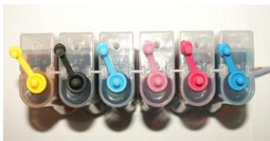
1. Открываем на емкостях СНПЧ вентиляционные отверстия (19).
