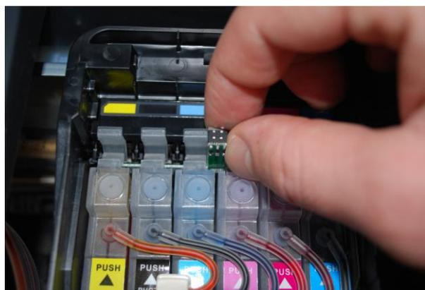
4. В позиции замены картриджей зажимаем кнопку обнуления чипа (16) двумя пальцами (чтобы не поломать) на 10 секунд.
