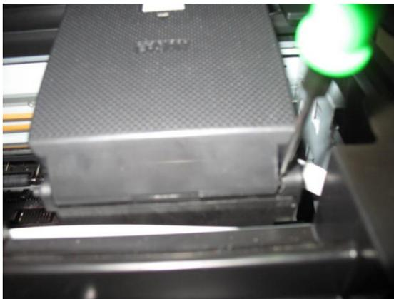
**3.** В позиции замены картриджей **ОТКРОЙТЕ КРЫШКУ ОТСЕКА ДЛЯ КАРТРИДЖЕЙ. ОЧЕНЬ-ОЧЕНЬ** медленно и осторожно отжимайте отвёрткой вправо правый фиксатор крышки каретки, а рукой отжимайте влево крышку каретки!!!! Как только фиксатор вышел из паза, вынимайте крышку каретки вверх.
