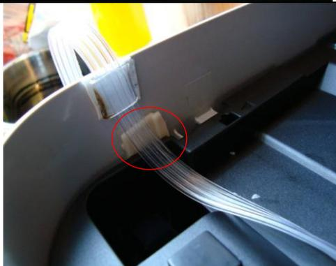
**F.** Для проведения шлейфа наружу корпуса, нужно оттянуть левую, боковую, крышку корпуса, вставить в образовавшийся зазор распорную пластину (6), сняв предварительно защиту со скотча. Прикрепите над этой пластиной крепление-клипсу 1 (7) (для шлейфа), а также прикрепите крепление-клипсу 2 (8) снаружи корпуса, с обратной стороны.
