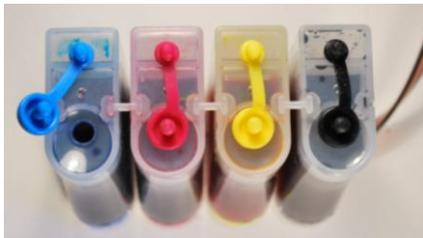
1. Закройте вентиляционные отверстия (20), откройте заправочное отверстие (21) емкости, в которую будете заливать чернила.
