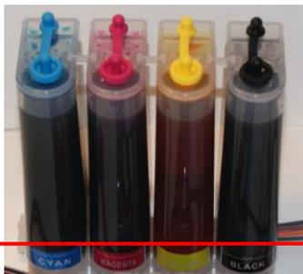
2. Дозаправив все емкости СНПЧ, закрываем заправочные отверстия (21) резиновыми пробками.
