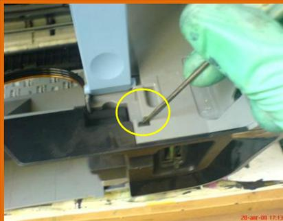
**С.** Для МР 140 и их клонов для скрытной проводки шлейфа можно снять лицевую панель, и продеть через неё шлейф. Подденьте отверткой защёлки.
