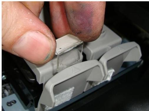
**D.** Установите крепление-уплотнитель (2) для шлейфа, на крышку цветного картриджа.
