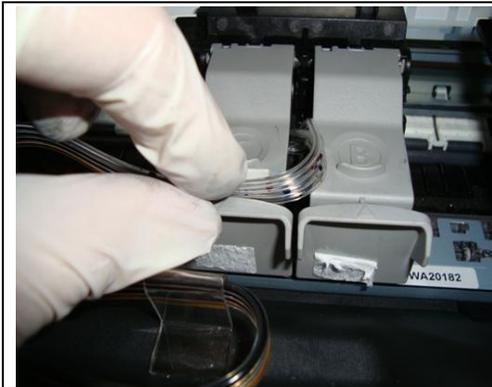
**Г.** Просуньте шлейф через крышку цветного картриджа. Шлейф СНПЧ должен быть плотно вставлен, чтобы не выскакивал из крышки.
