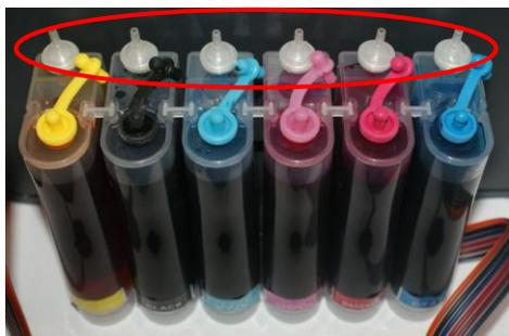
**3. На емкостях СНПЧ открываем вентиляционные отверстия (15), вставляем в них вентиляционные фильтры (1).**
