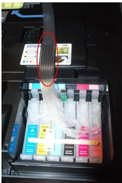
**2. Закрепите шлейф СНПЧ к корпусу принтера при помощи полоски двустороннего скотча**
