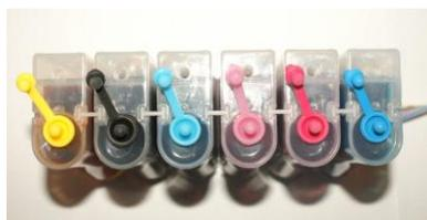
1. Открываем на емкостях СНПЧ вентиляционные отверстия (15).
