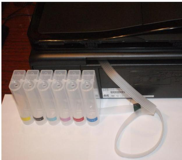
**3.** Наполовину приоткройте крышку принтера и просуньте шлейф СНПЧ к каретке принтера
