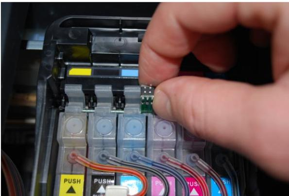
1. Чтобы обнулить чип необходимо, поднять крышку принтера и зажать кнопку обнуления чипа **(11) двумя пальцами** (чтобы не поломать) на 9 секунд.
