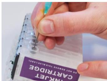
2. Берём картриджи СНПЧ (9), переворачиваем их и **АККУРАТНО** пробиваем иглой защитную пленочку на обратном клапане картриджей.
