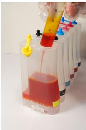
2. Открываем заправочное отверстие (16) на емкости, в которую будем заливать чернила. Затем берем шприц и вынимаем поршень. Вставляем носик шприца в заправочное отверстие (16). Используя шприц в качестве лейки, заливаем чернила в чернильную камеру (4). Залив чернила, закрываем заправочное отверстие (16). Аналогично заправляем остальные чернильные камеры, используя отдельный шприц для каждого цвета.
