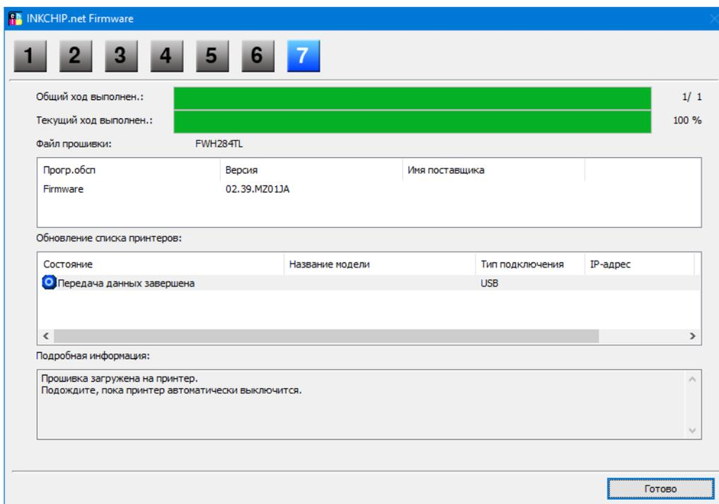
На этом этапе безчиповая прошивка будет загружена в принтер. О завершении процесса загрузки прошивки в принтер будет свидетельствовать надпись «FINISHED» на дисплее принтера. После этого нажмите кнопку «ДОМОЙ» на панели управления и принтер выключится.
