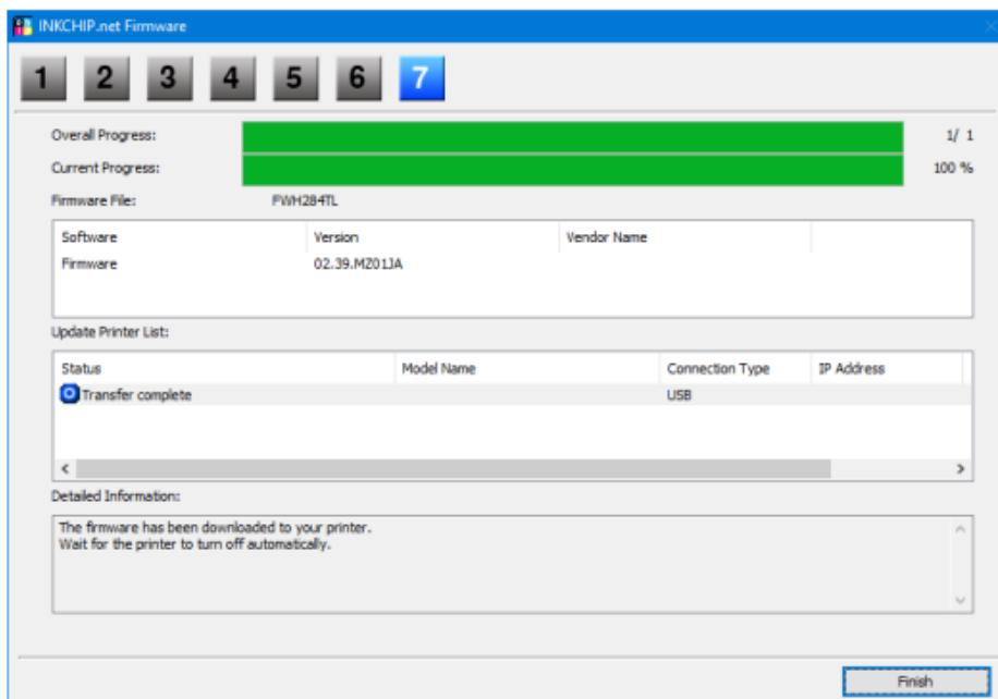
На этом этапе на принтер будет загружена бесчиповая прошивка. Завершение процесса загрузки на принтере будет обозначено словом «ЗАВЕРШЕНО» на дисплее принтера. После этого, нажмите кнопку «OK» на панели управления и принтер выключится.
